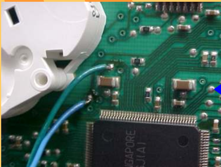
Fios Azul e Verde do cabo 4 vias soldados no painel do novo UNO
