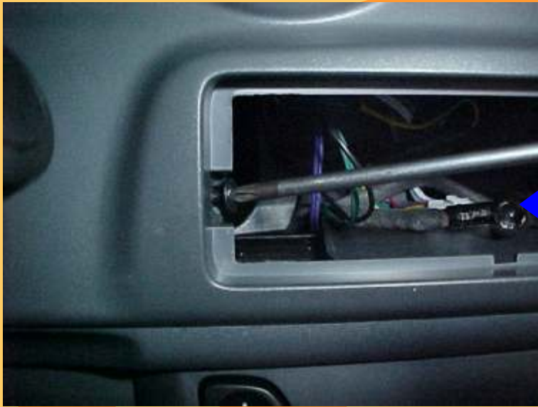
Desparafusando a carenagem debaixo do radio do painel do novo UNO
